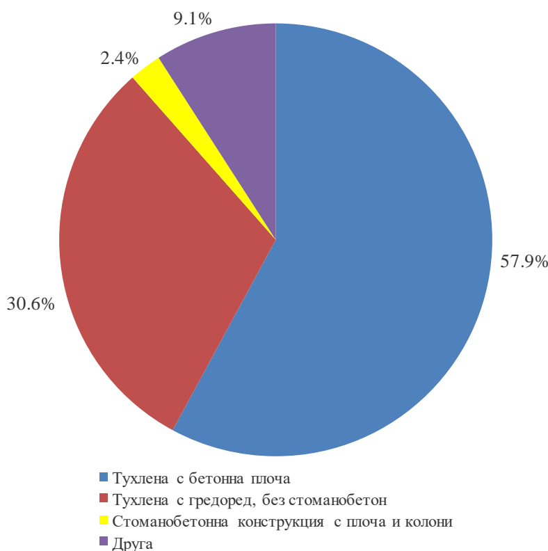
Фиг. 4. Структура на жилищните сгради в област Варна към 7 септември 2021 г. по вид на конструкцията и използвания основен материал
